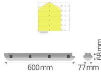
Technische Daten Ledvance LED Feuchtraumleuchte Feuchtigkeitsdicht Value 9W 1080lm - 840 Kaltweiß | 60cm
