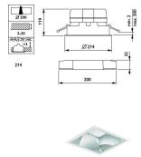
Technische Daten Philips LED Downlight LuxSpace Quadrat DN572B VLC-E 16.5W 2200lm 80D - 840 Kaltweiß | 214mm - Aluminium Reflektor - Dali Dimmbar
