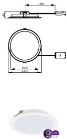
Technische Daten Philips LED Downlight Ledinaire DN065B Metall Weiß 19W 2000lm 110D - 830-840-865 CCT | 225mm - Ausschnitt 200mm - IP20
